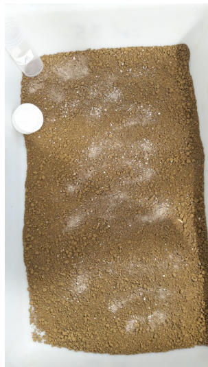
Figure 15. Mélange préalable dans un bac du sol et du produit solide (ici LDH (synt) avec le sol).
