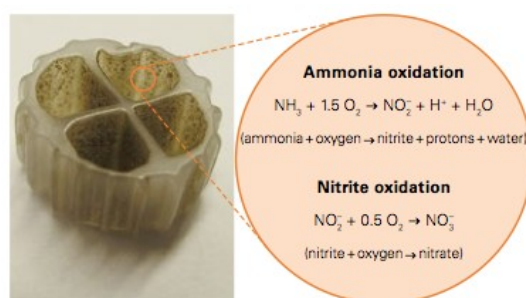
Figure 6. Support en plastique utilisé pour le développement des bactéries de nitrification (Etter et Udert 2015)
