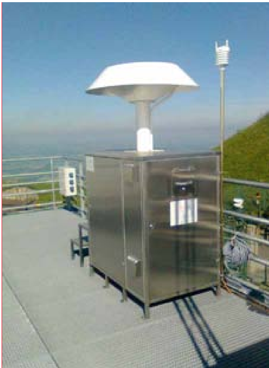
■ Figure III.24 - Station de collecte d'aérosol à très haut débit ( 700\text{ m}^3/\text{h} ) du réseau Opera-Air de l'IRSN (site du Puy-de-Dôme).
