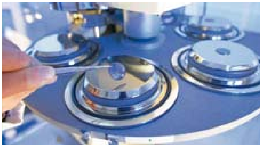
Figure 1.14 - Mesure par spectrométrie alpha sur chaîne de spectrométrie alpha de type chambre à grille.
