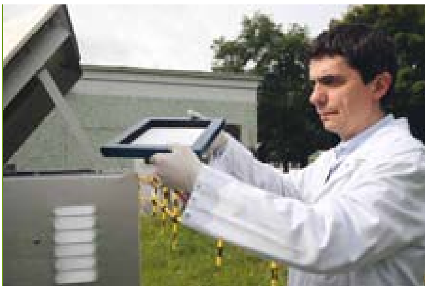
Figure I.8 - Prélèvement d'aérosols atmosphériques sur filtre.
