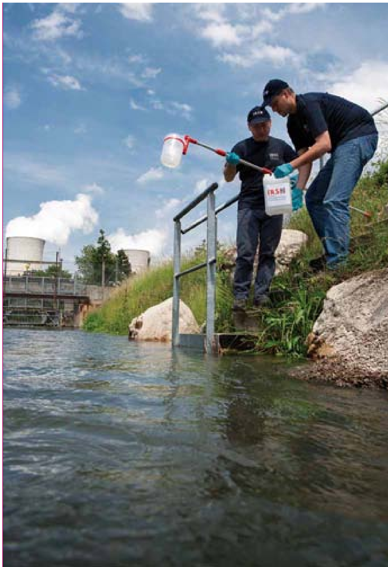
Figure VIII.10 - Prélèvement d'eau avec une perche télescopique dans la Gaffière en aval du site nucléaire du Tricastin.
