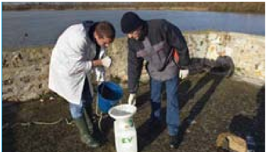
Figure VI.46 - Prélèvement d'eaux de l'Étang Vieux près du site de Saclay, pour analyses radiologiques et physico-chimiques.
