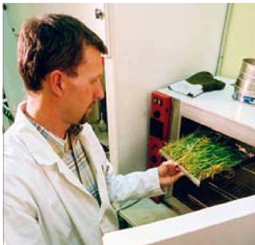
■ Figure V.144 - Mise à l'étuve d'un échantillon d'herbe.
