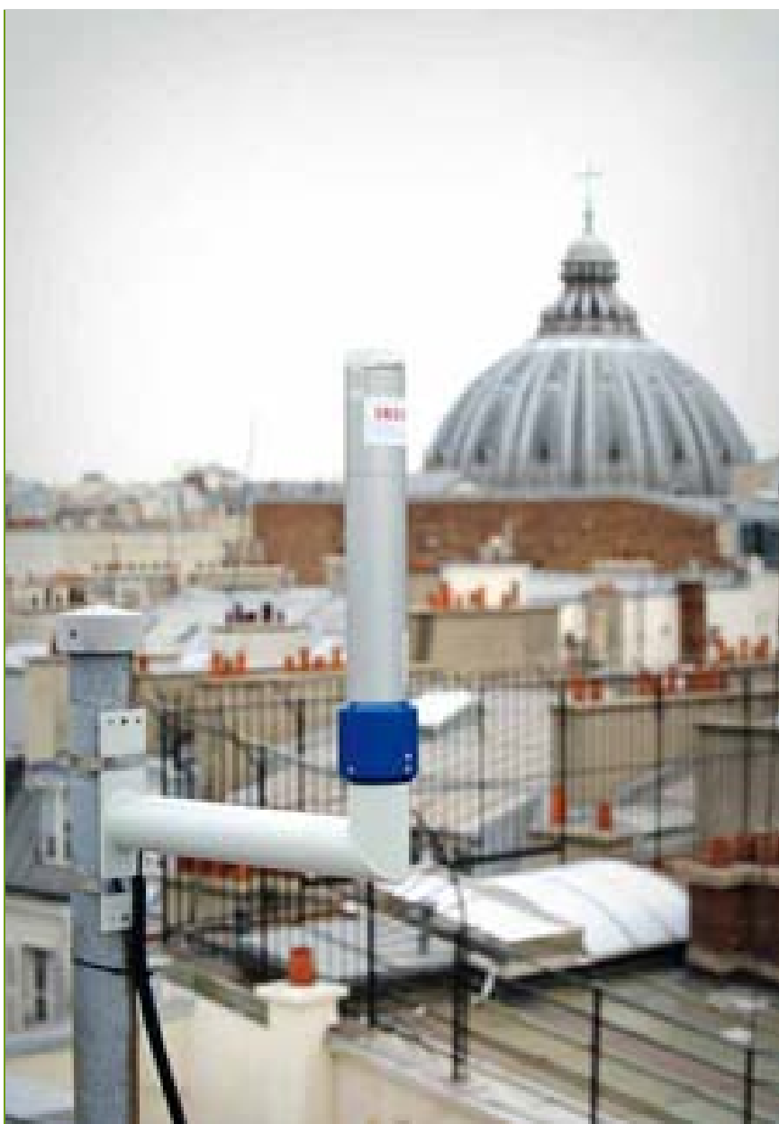
Figure I.9 - Balise Téléray IRSN (mesure du débit de dose gamma ambiant) de nouvelle génération installée à Paris (État-major de la Marine nationale).
