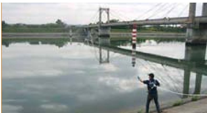
Figure V.26 – Prélèvement de sédiments dans le canal de Donzère-Mondragon en amont du site nucléaire du Tricastin.
