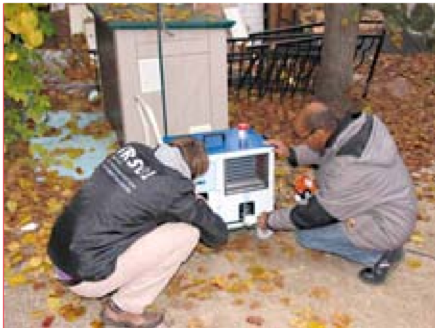
Figure III.17 - Prélèvement de vapeur d'eau dans l'air avec le système H3R-7000 dans la cour de 2M Process.
