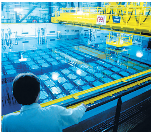
Piscine d'entreposage des combustibles usés à l'usine de retraitement d'Orano à La Hague
