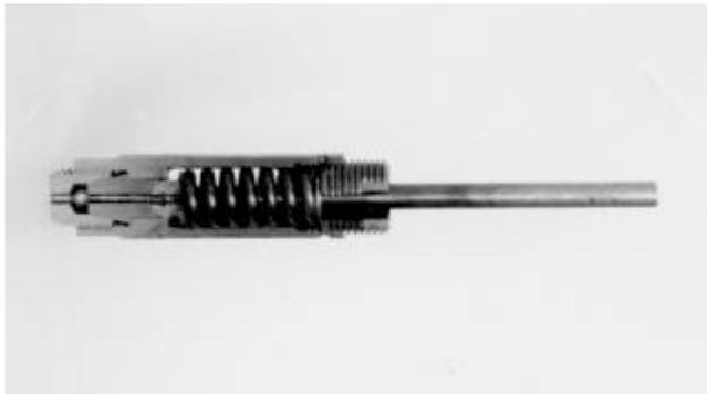
*Rotule d'un tube d'injection (Cliché STAé, 1938).*
