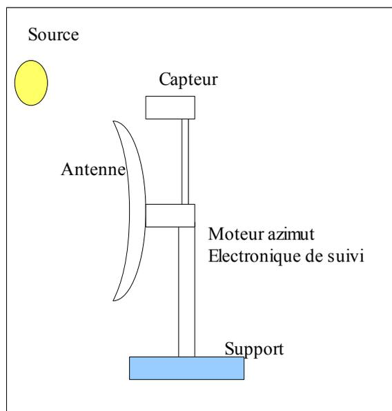
Si la source est trop à droite, ou trop à gauche, le moteur d'azimut corrige la chose en recentrant l'antenne.
