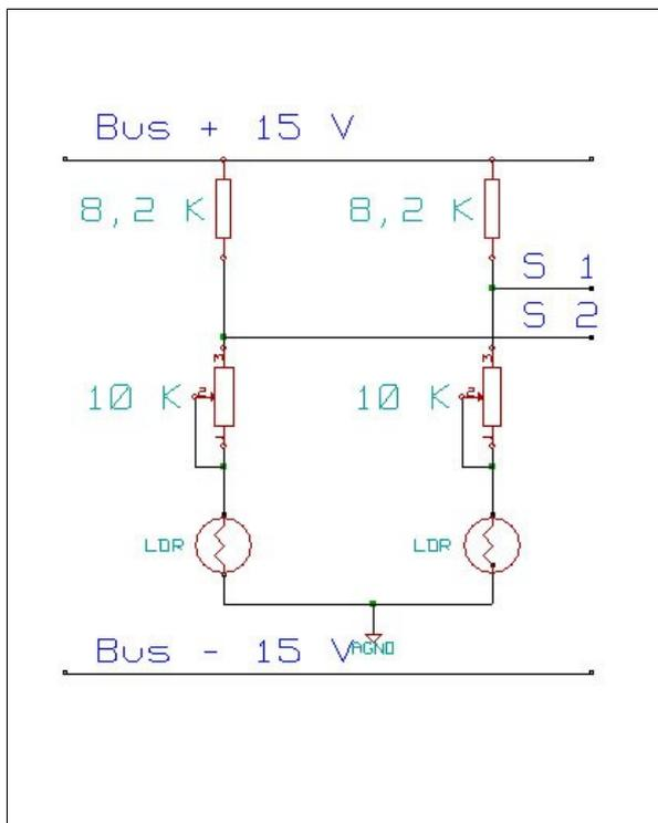
Quand le soleil n'est plus dans l'axe du capteur, l'une des LDR (Light Dépendant Résistor) est plus éclairée que l'autre (voir plus loin : le capteur). L'une des 2 sorties (S1 ou S2) est à un potentiel supérieur à l'autre.
