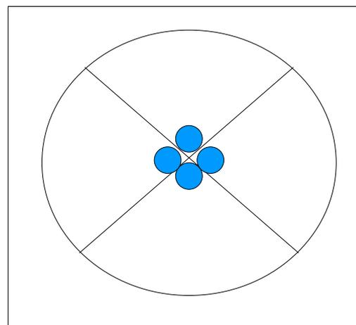
On obtient ainsi des données sur la position relative du soleil en site et en azimuth par rapport à l'orientation de la parabole.
