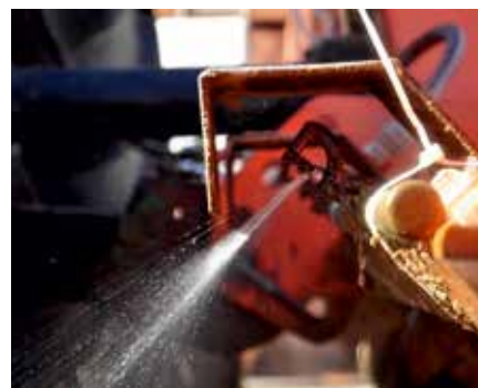
L'agriculteur épand les ferments lactiques pendant le fraissage, grâce à la mise en place de buses juste au-dessus des couteaux de sa fraise.
