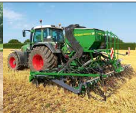
Les coupeaux ont une orientation de 87-90° afin de découper au maximum « à plat ». « Il est important qu'il n'y ait pas d'espace entre les rouleaux pour que l'ensemble du sol soit travaillé et éviter l'effet crête d'Iroquois. »
