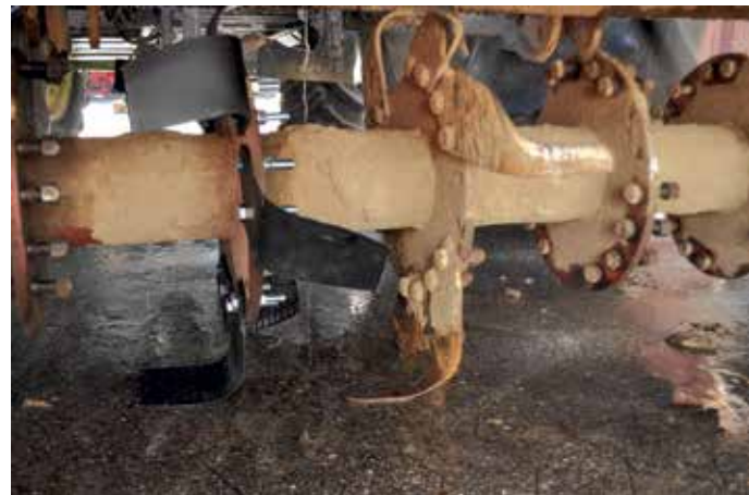
Les coupeaux ont une orientation de 87-90° afin de découper au maximum « à plat ». « Il est important qu'il n'y ait pas d'espace entre les rouleaux pour que l'ensemble du sol soit travaillé et éviter l'effet crête d'Iroquois. »
