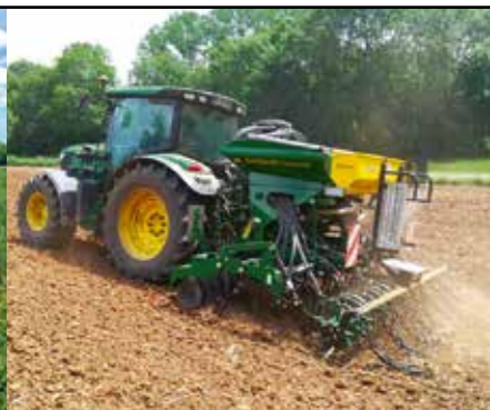
Les coupeaux ont une orientation de 87-90° afin de découper au maximum « à plat ». « Il est important qu'il n'y ait pas d'espace entre les rouleaux pour que l'ensemble du sol soit travaillé et éviter l'effet crête d'Iroquois. »
