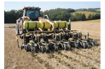
Passage de la traceuse de J.-P. Robert qui, de chaque côté du futur rang de maïs, dépose la féverole.
